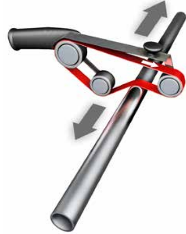
Цилиндрическое шлифование труб и прутков при помощи ручного инструмента
