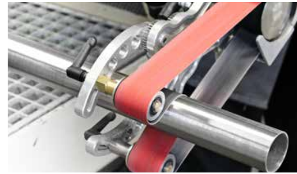
Цилиндрическое шлифование труб и прутков при помощи ручного инструмента
